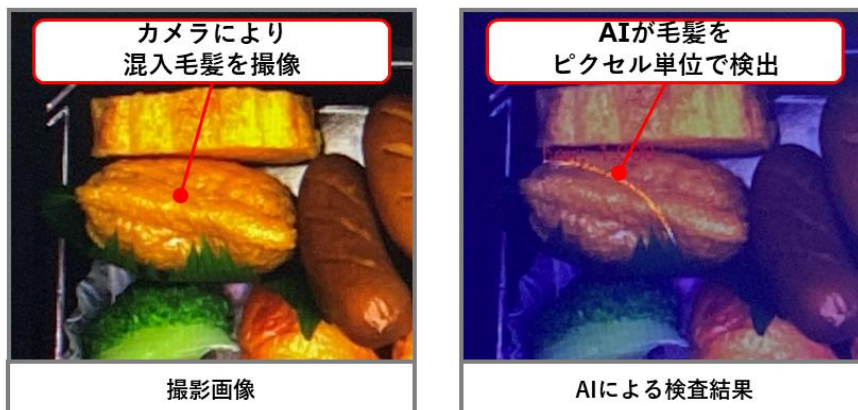
AIによる検査結果の表示画面（不良部分を拡大）
