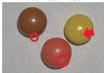
欠け・割れ・汚れ
